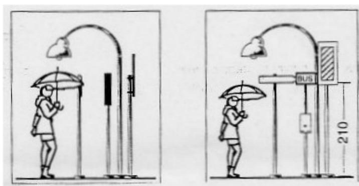
3. Ostacolo costituito da transenne e pali di sostegno di arredi ad altezza inferiore a cm 210, collocate sul percorso pedonale.
